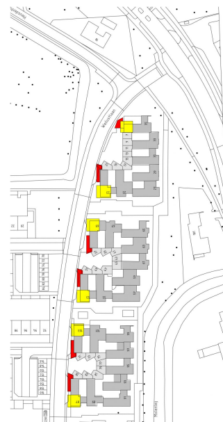
Geel is optopping, rood aanbouw
